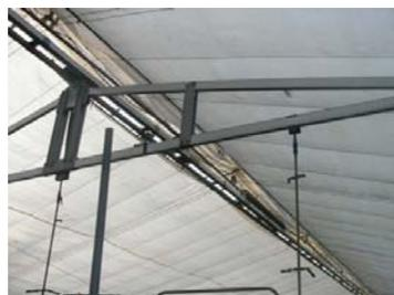
図8 農薬を散布する機械
