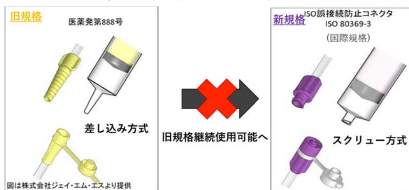
図 1 ミキサー食注入用のシリンジ規格変更（参考文献 3 に掲載されている図を引用して作成）
